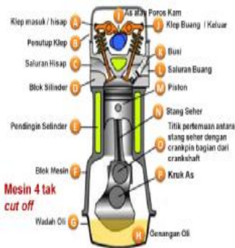
Gambar 2.1 Cara Kerja Sistem Motor 4 Langkah
